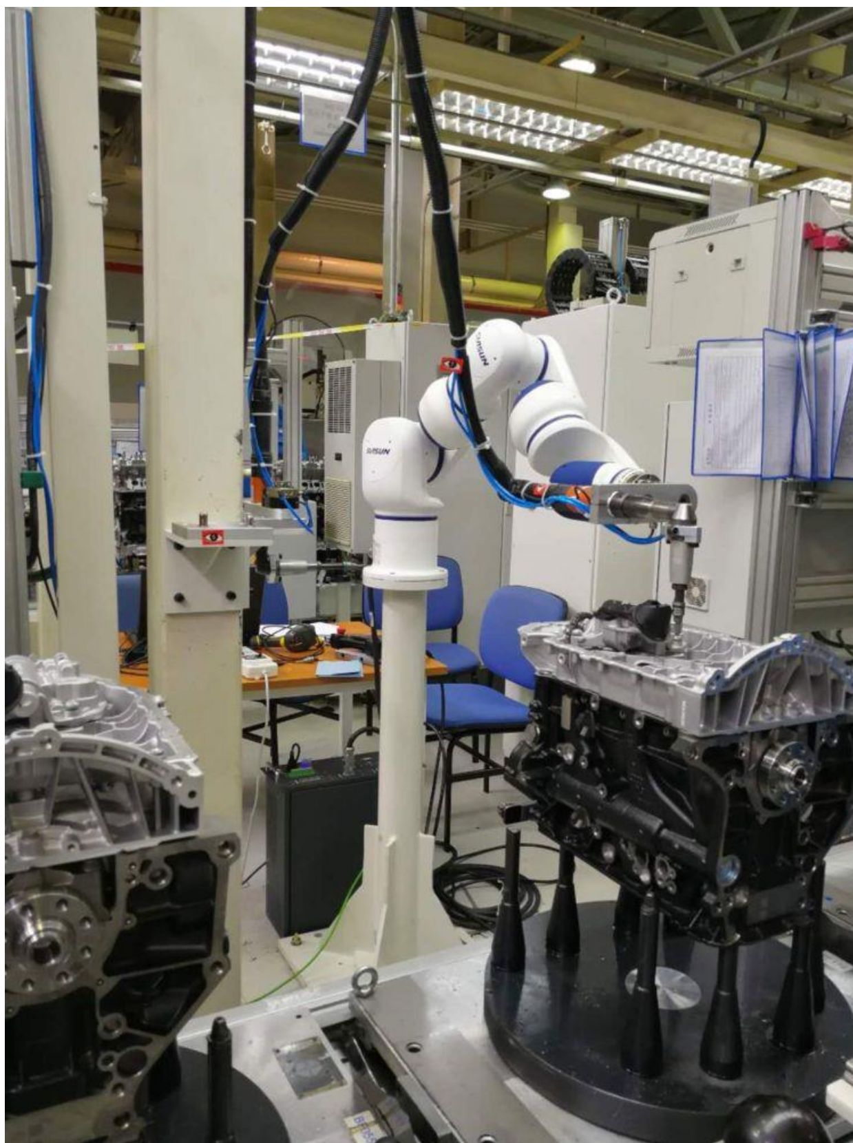
SCR5 porta una pistola di serraggio per completare il montaggio dell'ugello del motore, © immagine: SIASUN
