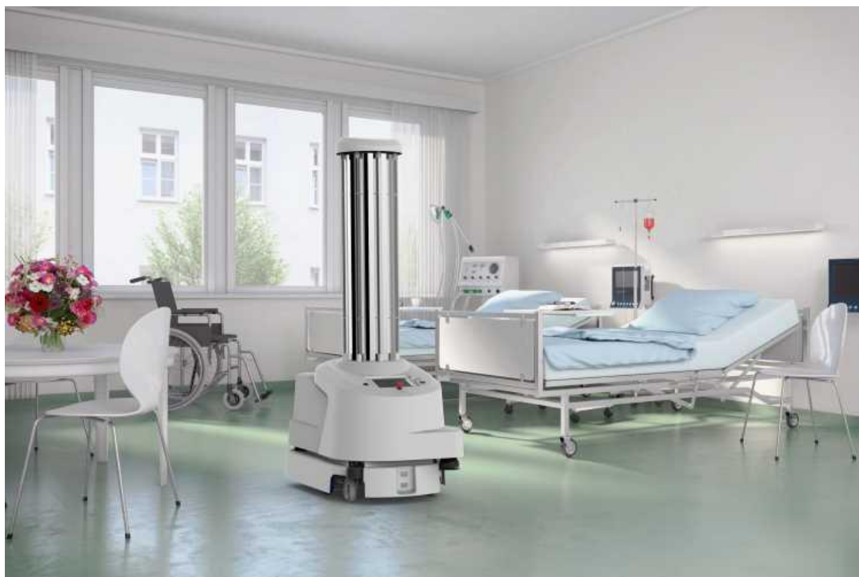
“UVD Robot” di Blue Ocean Robotics guida autonomamente ed elimina batteri e altri microrganismi dannosi negli ospedali © Blue Ocean Robotics
