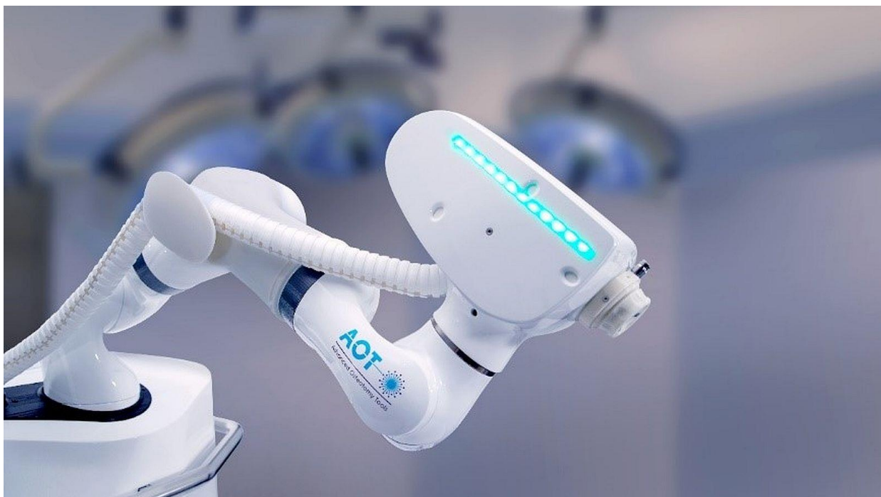
CARLO: Sistema laser robotizzato per chirurgia ossea con l'aiuto di LBR Med (© image AOT AG)
