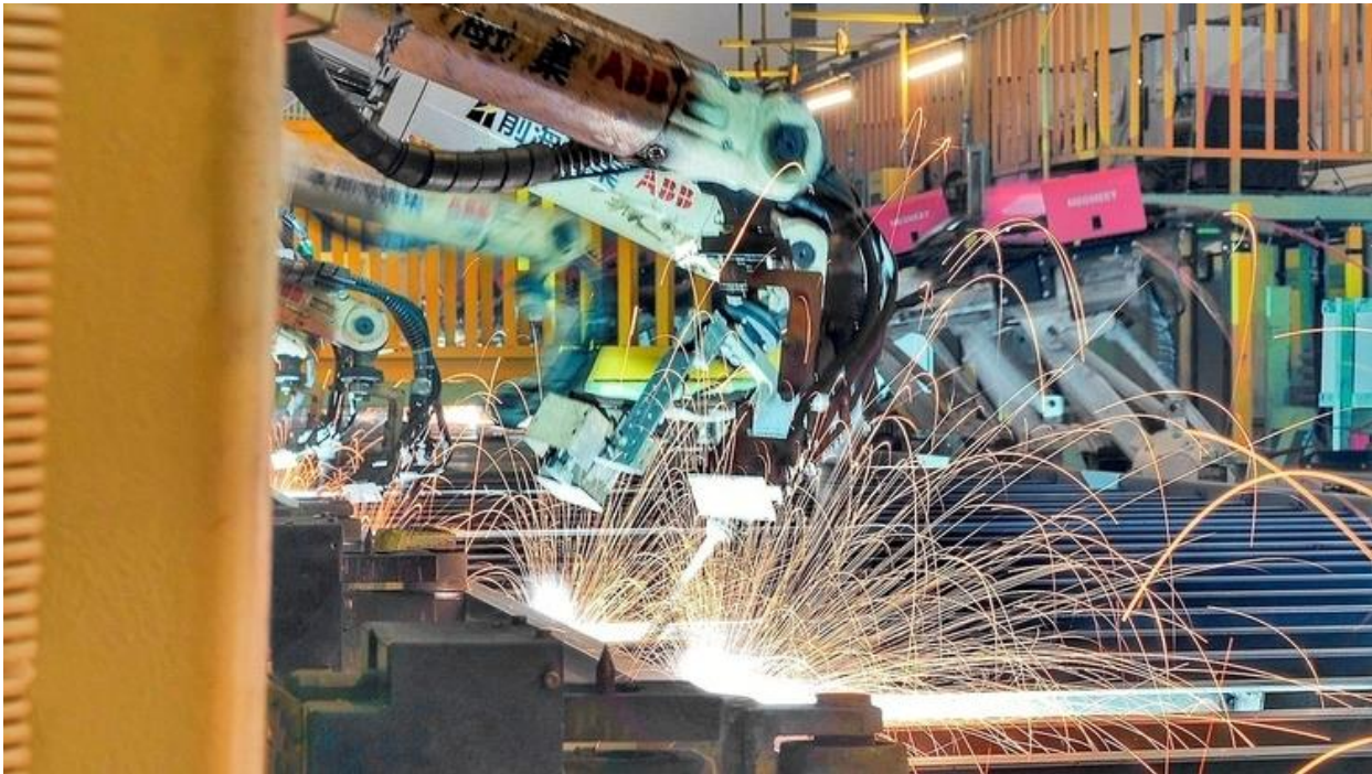
Linea di produzione di saldatura in cui i robot ABB eseguono attività di saldatura © ABB
