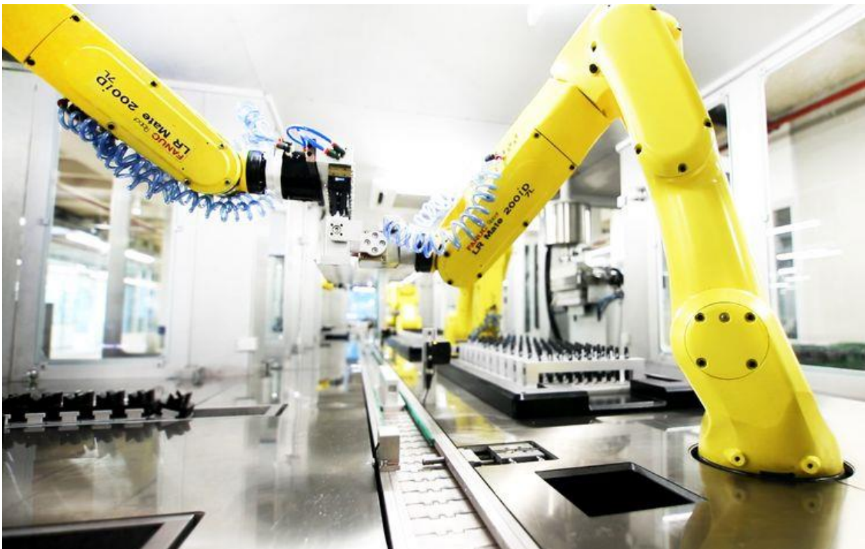
Gestione delle parti tra robot – FANUC LR Mate 200iD/7L ©Fanuc Europe Corporation
