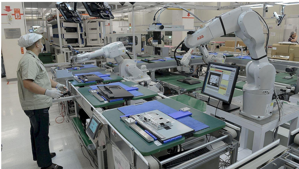
Robot in catena di montaggio nell'industria elettronica © ABB
